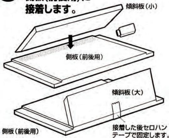
**2** 傾斜板と側板(前後用)がしっかり接着されてから、両側に側板と側板止め板を接着します。
