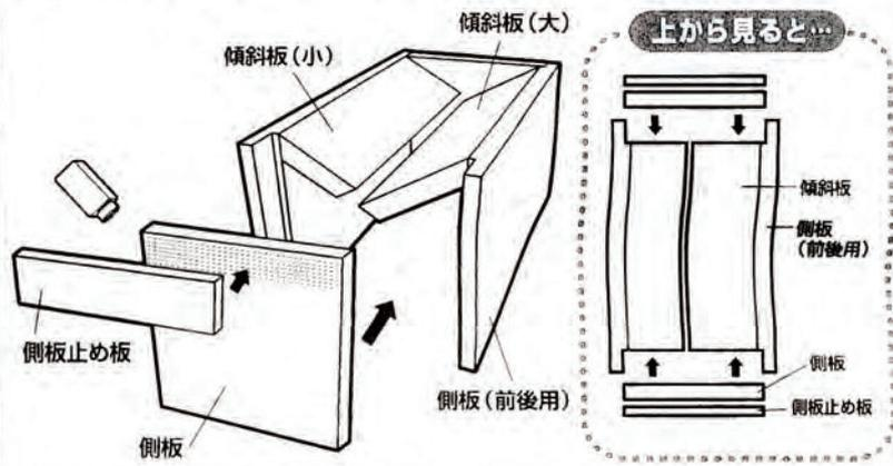
**3** 完全に接着し終わったら、底板と脚を接着し組み立て完成です!
